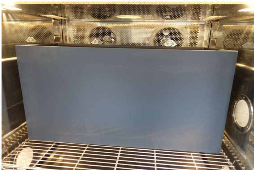
Einlagerung Fiberglas - Pflanzkübel in Kammer WKS-800
